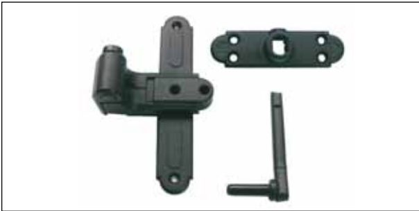
ΡΥΘΜΙΖΟΜΕΝΟ ΜΑΣΚΟΥΛΟ (MACO) ADJUSTABLE HINGE FOR SHUTTER SASH (MACO) MACO 01 No1. 5.5 - 8cm MACO 02 No2. 8.5 - 12cm MACO 03 No3. 12.5 - 17.5cm MACO 04 No4. 17.5 - 19cm MACO 012 ΜΕΝΤΕΣΕΣ/HINGE
